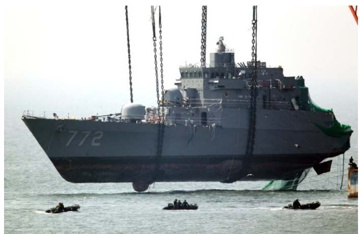
Das Bugteill der gesunkenen "Cheonan" wird von einem Schwimmkran geborgen (Foto: AP)
