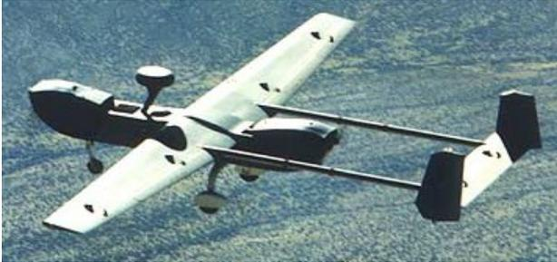
**UAV Hunter:** Länge 7,01 m; Spannweite 8,84 m
